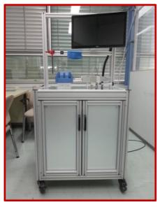
Bei der Firma Moog GmbH wurde ein pneumatischer Prüfstand für hydraulische Proportionalventile entwickelt. Mithilfe dieses Prüfstandes soll künftig ein sehr aufwändiges hydraulisches Prüfverfahren ersetzt werden. Durch diese Maßnahme werden Fertigungsschritte und Kosten eingespart. Planung, Konstruktion, Umsetzung und Inbetriebnahme erfolgte durch das Projektteam.
