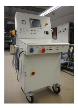
Aufbau eines Spannungs- und Signalsimulator (Bild) für die Simulation und Darstellung verschiedener Spannungsbereiche, definierter Ströme, digitaler sowie analoger Eingangswerte und Ausgangswerte. Das Gerät wird für Funktionsprüfungen von Schaltschränken eingesetzt.
