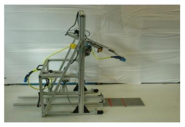
Bislang gab es im Mercedes Benz Werk Sindelfingen noch nicht die Möglichkeit eine automatische Simulation für das Laden und für den Steckvorgang des Ladekabels an Elektro- oder Plug-In-Hybrid-Fahrzeuge durchzuführen. Diese Tests werden derzeit manuell von einem Mitarbeiter ausgeführt. Das Technikerteam entwickelte einen mobil einsetzbaren Prüfstand, der die verschiedenen Ladevorgänge automatisiert durchführt.
