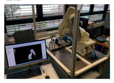
Für den Robotikunterricht wurde ein neues Übungsobjekt benötigt. Die Planung, Aufbau und Inbetriebnahme erfolgte durch die Technikergruppe. In Zusammenarbeit mit der GDS1 wurden ein Förderband und ein Greifer entwickelt. Die Roboterzelle entspricht den heutigen Anforderungen an Industrie 4.0 und soll in den nächsten Jahren den Berufsschülern die Möglichkeit geben, unterschiedlichste Aufgaben am Roboter zu programmieren und verschiedene Positionen anzufahren.
