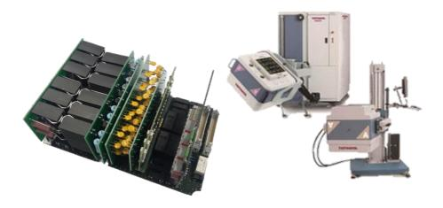
Es wurde eine neue Platine entwickelt, die es ermöglicht, die Software der neuen Chiptester-Generation 24/7 zu prüfen. Die Platine simuliert dazu einen Mikrochip. Dabei wird ermittelt, ob die in der Software eingestellte Spannung und der entsprechende Kanal auch an der Platine richtig ankommen.
