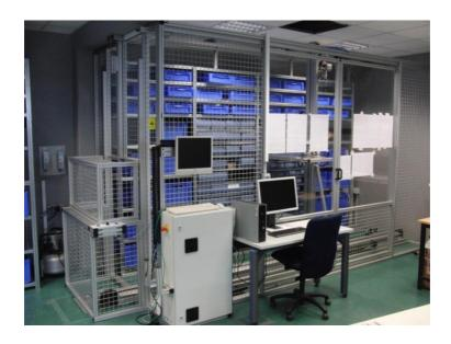
In der Werkstatt des B-Gebäudes der GDS2 steht ein Regal-Bedien-Gerät RBG, das revitalisiert (überholt) werden musste. Das RBG wird über eine Bedienoberfläche am PC gesteuert. Kisten mit Material werden automatisiert eingelagert und ausgelagert. Planung, Umbau, Programmierung und Inbetriebnahme erfolgte durch das Technikerteam.
