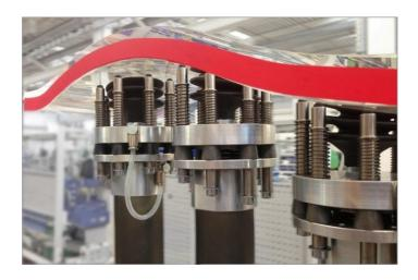
Die Anfertigung einer flexiblen Bauteilauflage für Rohbauteile ist ein Schritt zu Industrie 4.0. Bisher werden noch Flexauflagen (Bild) für Rohbauteile anderer PKW-Modelle auf einer Ablagestation montiert und manuell eingestellt. Die Einstellung dieser Auflagen kann nun vollautomatisiert erfolgen. Die Einstellung wird darüber hinaus im Anschluss durch ein Messsystem auf Richtigkeit überprüft.
