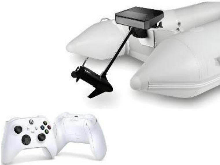
In unserem Projekt haben wir eine moderne elektrische Steuerungseinheit für den Außenbordmotor eines Schlauchboots entwickelt. Unsere Steuerungseinheit basiert auf einer Mikrocontroller-Architektur und ermöglicht die stufenlose Regelung von Lenkung und Leistung. Die Bedienung erfolgt komfortabel über einen kabellosen Controller, wodurch herkömmliche mechanische Steuerungen ersetzt werden.
