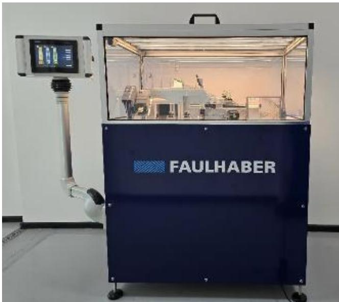
Unser Technikerprojekt wird durch einen automatisierten Messeaufbau mit hochdynamischen, aber auch mehrachsigen Transporttechniken realisiert. Die Aufgabe des Messedemonstrators ist es, Schokoladen anhand der Farbe ihrer Verpackung zu erkennen und anschließend auf die passende Rampe zu sortieren. Die Besucher der Messe können über den Touchscreen eine der drei Sorten auswählen. Diese wird nach dem Sortierprozess ausgegeben.
