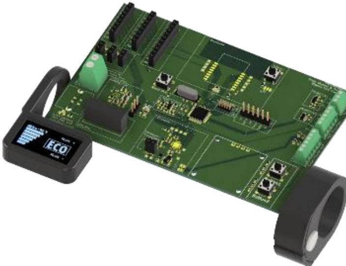
Das Projekt beinhaltet die Planung und Entwicklung einer Bedieneinheit mit Display für einen nachrüstbaren Elektroantrieb der Firma Aden GmbH. Dieser Antrieb bietet dem Endverbraucher nur wenige Einstellmöglichkeiten und Funktionen. Durch unsere Bedieneinheit wird der Funktionsumfang um eine präzise Akkuanzeige, verschiedene Fahrmodi und eine Trip-Speicherfunktion erweitert.
