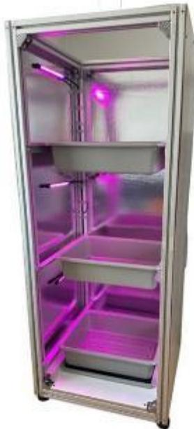
Unser Projekt "Das digitale Gewächshaus – JYND" ist ein smartes, vollautomatisiertes Gewächshaus. Sensoren messen Temperatur, Luft- und Bodenfeuchtigkeit, während automatisierte Systeme Beleuchtung, Bewässerung und Belüftung steuern. Die Steuerung erfolgt über einen Raspberry Pi mit Dashboard-Überwachung. Ziel ist es, Hard- und Software zu verbinden und moderne Technik effizient zu nutzen. Das Projekt fördert Teamarbeit, Problemlösung und nachhaltige Pflanzenzucht.
