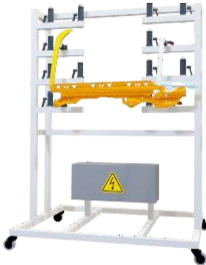
Ein Fond-Seitenrollo elektrisch (FSE) ist ein motorisiertes Fensterrollo in den hinteren Fahrzeugtüren für Sicht- und Sonnenschutz. Das von uns entwickelte Testgestell ermöglicht eine schnelle und effiziente Prüfung der FSEs im ausgebauten und im eingebauten Zustand. Außerdem ist es baureihenübergreifend für aktuelle und zukünftige Fahrzeugmodelle einsetzbar.
