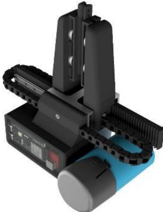
Das Projekt beinhaltete die Weiterentwicklung eines bestehenden Greifersystems. Hierbei wurde die externe Stromversorgung durch einen integrierten, wechselbaren Akku ersetzt und die Greiferstruktur neu konstruiert. Zusätzlich wurde die Ansteuerung des Systems überarbeitet, sodass der Greifer kabellos über WLAN betrieben werden kann.
