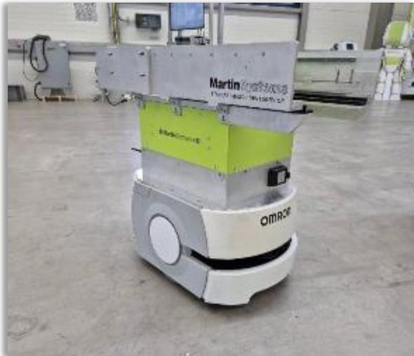
Die beim Kunden angebotenen AMR (Autonomous Mobile Robot), sollen die Möglichkeit haben, kabellos mit bereits vorhandenen Maschinen kommunizieren zu können. Dafür haben wir eine universelle Schnittstelle mit Hilfe eines Mikrokontrollers entwickelt, mit der Daten über mehrere Kommunikationskanäle ausgetauscht werden können.
